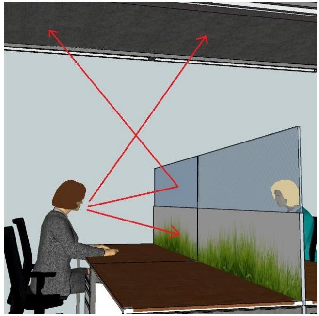
Das Ziel guter Büroakustik - maximale Schallpegelabnahme mit der Entfernung zur Quelle und minimale Sprachverständlichkeit - wird durch die Kombination von Akustik-Trennwänden mit Schallabsorbern an der Decke erreicht. Die Skizze oben rechts zeigt den abschirmenden Effekt der Trennwand und die Absorption von Schallwellen an den Schallabsorbern im unteren Trennwandbereich sowie an der Decke.
