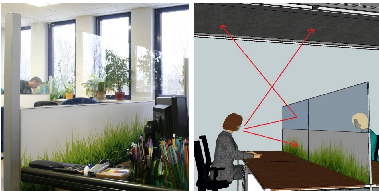
Figur 1: Akustisches Prinzip von Bürotrennwänden
