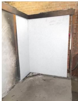
Abb: Kante großer Probenflügel Probenbefestigung
