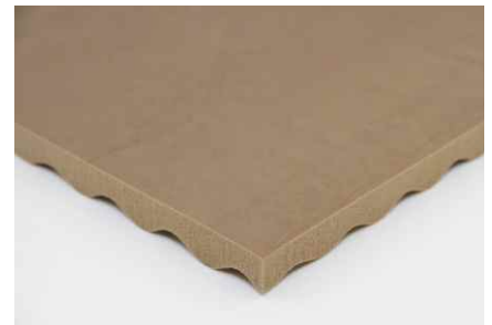
Acoustic Floor Mat 31 Lastbereich: 5000 kg/m 2 Dyn. Steifigkeit s_t' \leq 17 \text{ MN/m}^3 Trittschallverbesserungsmaß \Delta L_w \geq 31 \text{ dB}
