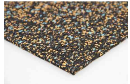
Acoustic Floor Mat 23 Lastbereich: 5000 kg/m 2 Dyn. Steifigkeit s_t' \leq 35 \text{ MN/m}^3 Trittschallverbesserungsmaß \Delta L_w \geq 23 \text{ dB}
