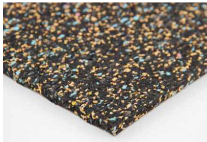
Acoustic Floor Mat 26 Lastbereich: 5000 kg/m 2 Dyn. Steifigkeit s_t' \leq 20 \text{ MN/m}^3 Trittschallverbesserungsmaß \Delta L_w \geq 26 \text{ dB}
